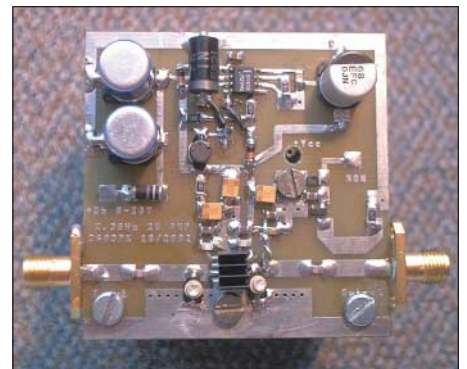
Bild 2: Blick auf die bestückte Platine; unten sind Striplines und MMIC zu erkennen.
